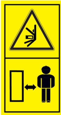
Seien Sie sich der Gefahren bewusst, die von beweglichen Teilen der Maschine ausgehen. Betreiben Sie die Maschine unter keinen Umständen, wenn sich in der Nähe oder in der Nähe befinden Passanten im Arbeitsbereich.
