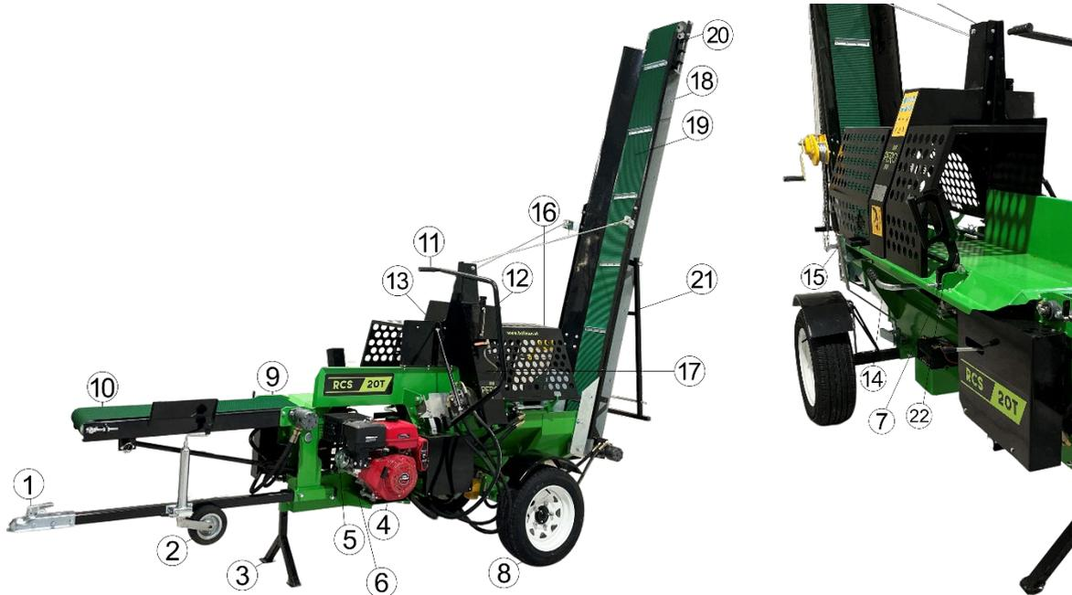
1. **2“-Kupplung:** Schließen Sie den Schneidspalter an Ihr Fahrzeug an. Nur für runde 2-Zoll-Anhängerkupplungen geeignet.
