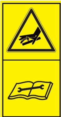
Gefahr durch austretendes Hydrauliköl unter hohem Druck!
