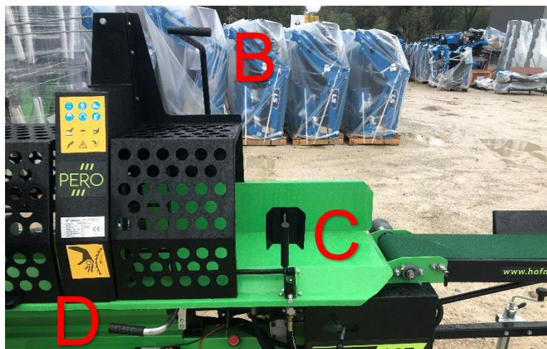
7. Das geschnittene Stück fällt in den Spaltbereich und wenn Sie den Sägegriff anheben, rastet der Kolben des Schubzylinders automatisch ein. Es ist auch möglich, den Schubkolben manuell mit dem Hebel D zu betätigen.
